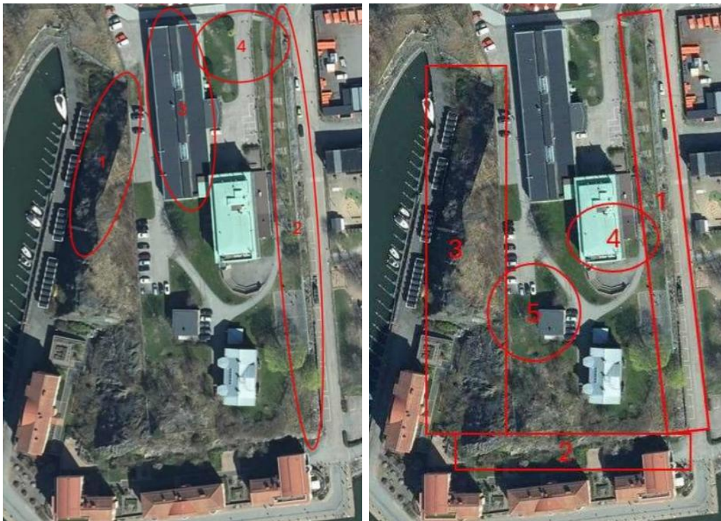
Figur 47 Kartan till vänster visar undersökta delområden i den bergtekniska undersökningen för fastigheten Lindholmen 6:9. Kartan till höger visar undersökta delområden i den bergtekniska undersökningen för fastigheten Lindholmen 6:11.
